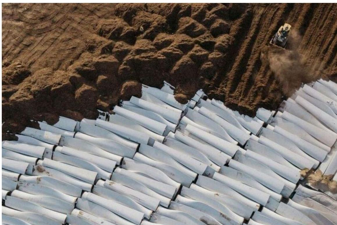
Рисунок 3 — Неэкологическая технология захоронения лопастей
