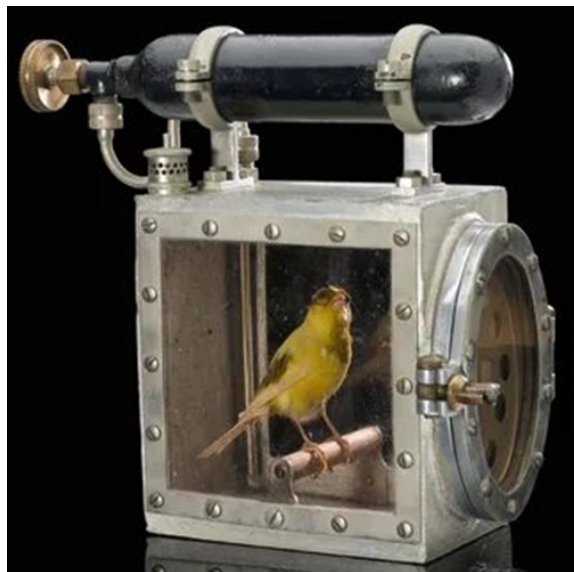
Рисунок 2 — Практическая реализация индикатора рудничного газа — канарейка
