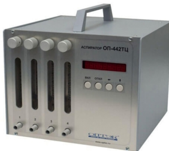
Рисунок 4 — Пробоотборник ОП 442 ТЦ
