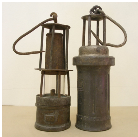
Рисунок 1 — Первый в истории газоанализатор (лампа Дэви)
