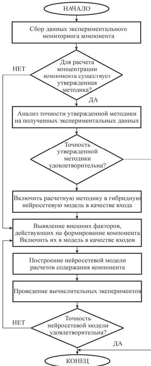
Рисунок 1 — Методика применения нейросетей для расчета концентраций компоненты химического состава в воде
