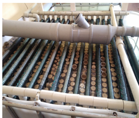
Рисунок 2 Вертикальный сетчатый биофильтр с подвесным угольным фильтром водоподготовки
