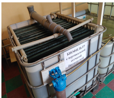
Рисунок 2 Вертикальный сетчатый биофильтр с подвесным угольным фильтром водоподготовки
