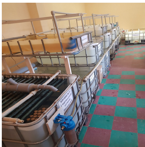
Рисунок 1 Малогабаритная трехъярусная УЗВ
