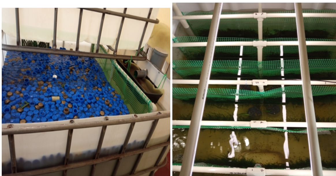
Рисунок 4 Биофильтр с плавающей пластиковой биоагрузкой (слева) и биоплато с яванским мхом (справа) в блоке очистки воды УЗВ № 2
