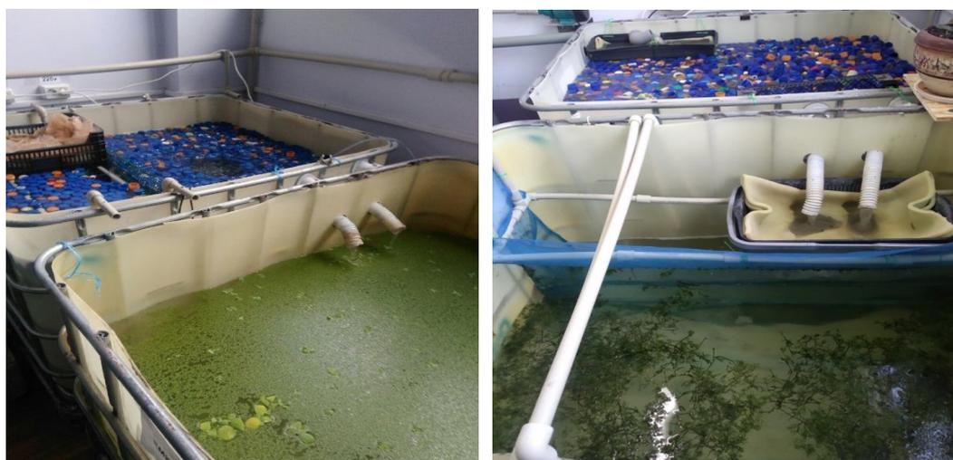
Рисунок 4 Биофильтры и биоплато в УЗВ цеха выращивания товарной рыбы
