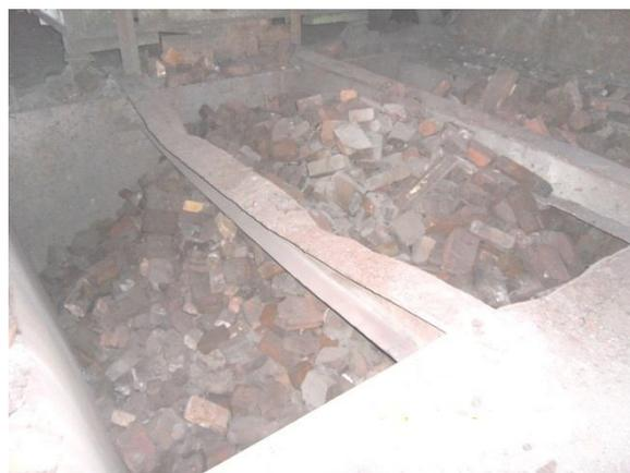
Рисунок 3 Отходы огнеупорного кирпича
